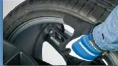
Die Techniker legen einfach den Messarm an die Felge an und das System gibt automatisch die Felgenmaße ein und wählt den geeigneten Auswuchtmodus.
